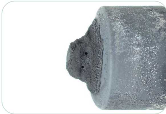
Dieselsbe Einspritzdüse nach 5.000 km mit Shell FuelSave Diesel.
