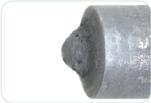
Verschmutzte Einspritzdüse in einem britischen LKW nach Verwendung von Standard-Diesel.
